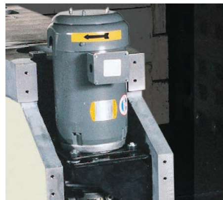
液压油泵总成安装在左后冲床床身脚座。
