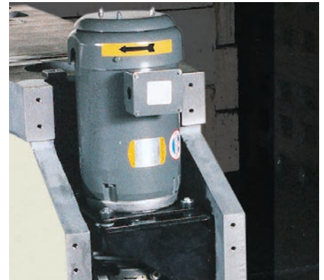
Hydraulikmotorpumpe am linken hinteren Teil des Pressentisches montiert.
