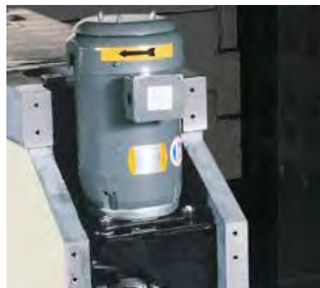
Conjunto de bomba de motor de hidráulico montado en la pata de la bancada de presión trasera izquierda.
