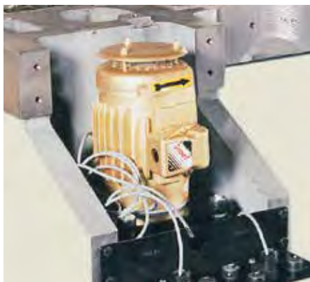
Conjunto de bomba de motor de lubricación montado en la pata de la bancada de presión trasera derecha.
